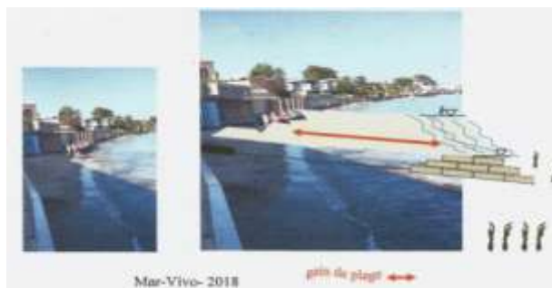
Fig. 3 -Schéma d'un ouvrage 3 nappes : gain de \approx 8 m (* Dispositif parafouille (fig 4)
